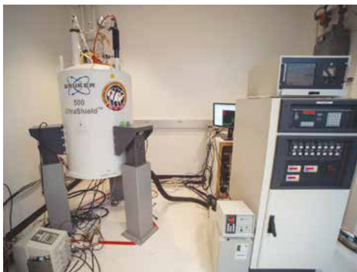
Obr. 1: Nukleární magnetická rezonance (Bruker Avance IIIITM 500 MHz). Zdroj: https://amris.mbi.ufl.edu/spectrometers-2/500mhz-54mm/
